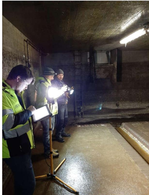
Die Aufnahmen sollten weder das Personal, das Arbeitsmaterial noch Objekte, die nicht fix im Bauwerk enthalten sind, erfassen. Daher ist es notwendig vor allem die Scheinwerfer und die dazugehörigen Kabel mehrfach zu verschieben. Während der Aufnahmen sollte mehrmals eine optische Kontrolle der Bilder durchgeführt werden, ob diese der gewünschten
