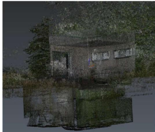
Abbildung 36: Ergebnismodell der Leica BLK2GO, Bauwerk AWW Schwechat (Geo4you 19.08.2021)
